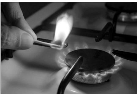
liklər açılmalı və ya qapalı mühitdə qaz yandırılarkən nəfəsliklər açıq olmalıdır. Otaqlarda quraşdırılmış qızdırıcı sobanın fəaliyyətinə vaxtaşırı fasilə verilməlidir. Bu zaman otaqda havanın dəyişdirilməsi üçün pəncərələr açılmalıdır. Unutmayın ki, mənzil mütəmadi havalandırıldıqda dem qazından zəhərlənmə riski azalır.
